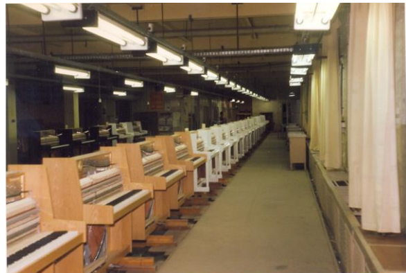
Die Klaviere standen auf Schlitten auf den Gleisen. Hier sind sie fertig vorbereitet zum ausarbeiten und regulieren Foto: R. Strietzel
